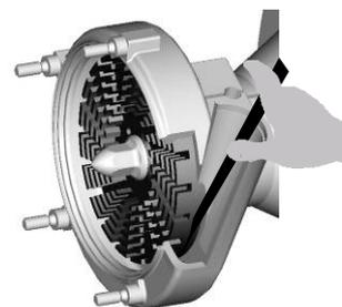
用塞尺调整叶轮与泵体的间隙(Y)
